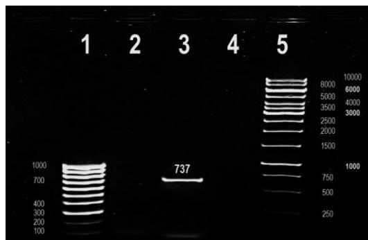
**Figura 3. PCR para la detección del gen *hlyA* en *Aeromonas* spp.** 1, Marcador de Peso Molecular (100 pb). 2, Control Negativo. 3, *A. hydrophila* ATCC7966  $\beta$ -hemolítica (737 pb). 4, *A. hydrophila* no hemolítica aislada de ostras. 5, Marcador de Peso Molecular (Thermo Scientific® 1 kb).
